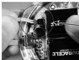
El conector del cable se inserta en el receptáculo de la placa de circuito del teclado.
